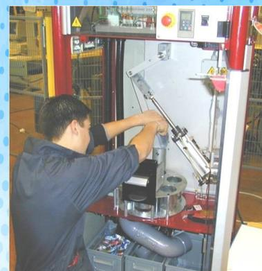
TP : Réaliser la maintenance corrective sur un système automatisé de compactage
