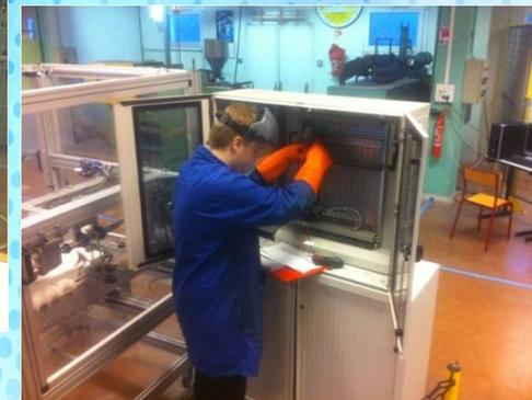
TP : Mesure des énergies électriques sur un système automatisé de tri
